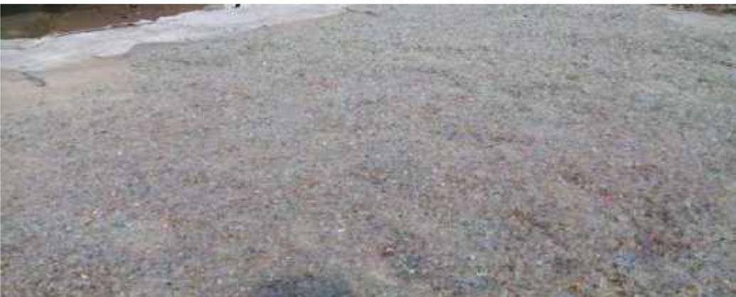
Gambar proses pengeringan cacahan plastik secara manual yaitu dengan bantuan sinar matahari
