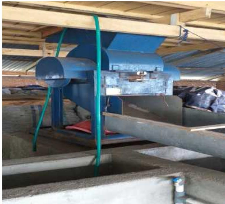
Gambar mesin pencacah Limbah plastik
